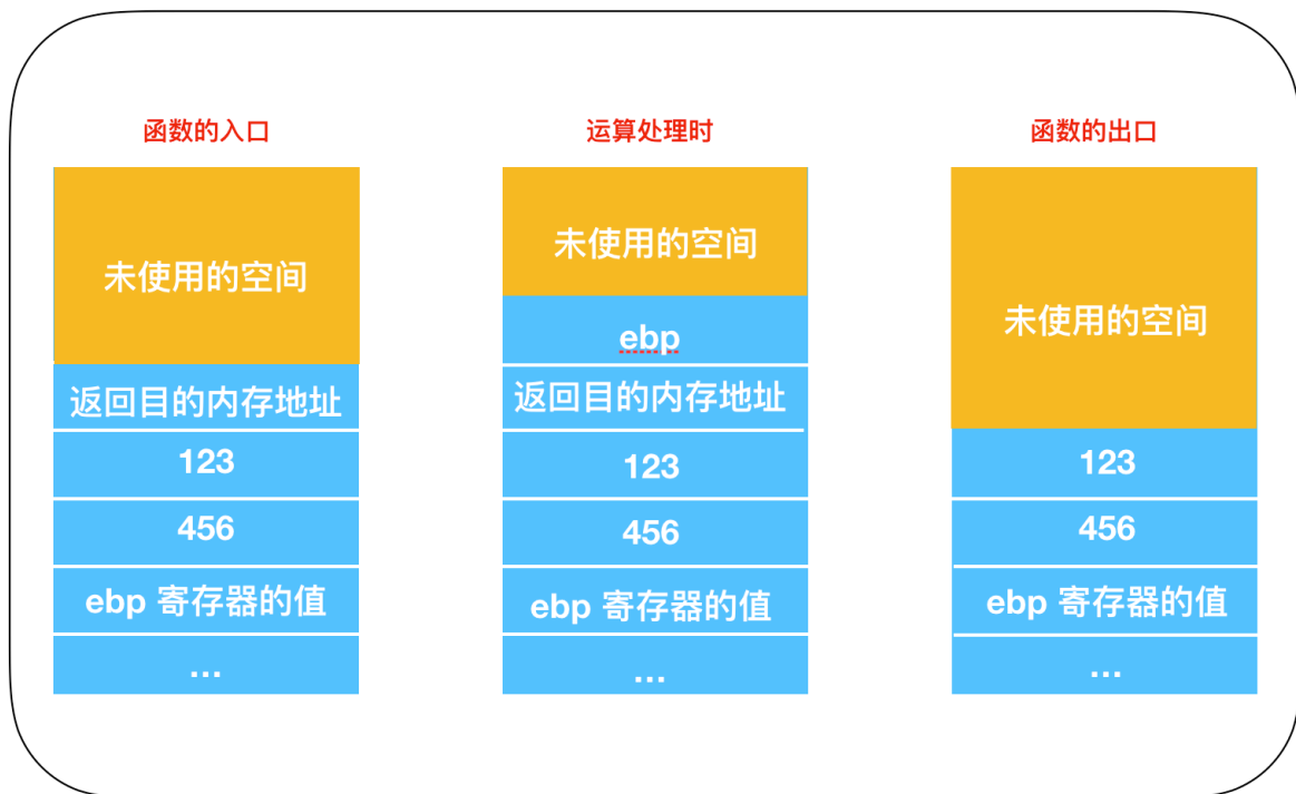
AddNum 函数内部的栈状态变化
